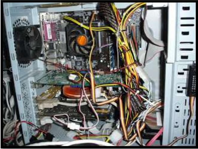
**2º Passo** é retirar a fonte de alimentação, diminuindo a quantidade de cabos no computador e liberando espaço dentro do gabinete. Para a retirada da fonte, precisamos fazer a retirada dos parafusos que se encontra na parte de trás do gabinete.
