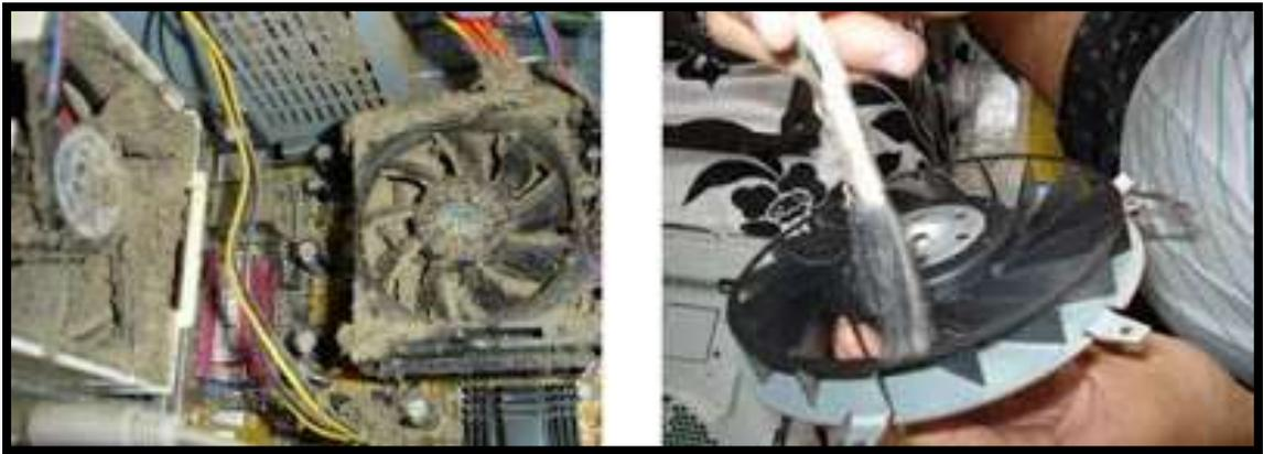
Há também a opção de realizar a limpeza do computador com um compressor de ar, onde neste caso não é necessário a remoção dos componentes, porém, temos q tomar cuidado na hora de limpar pois o compressor elimina água durante sua utilização, então não podemos deixar cair água na placa-mãe e nem nos seus componentes.
